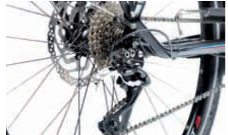
Gut für Speed und Biss am Berg: 10 Gang-Kettenschaltung; Scheibenbremse.
